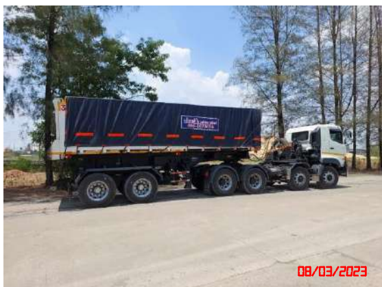
รูปที่ 14 การใช้ผ้าใบปิดคลุมรถบรรทุกและป้ายเตือน
